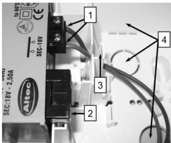
1- La phase et le neutre du secteur se branchent sur le bornier à vis présent sur le dessus du transformateur.
