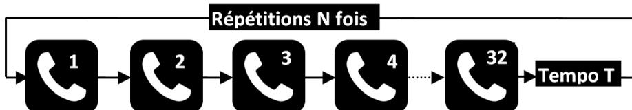
Le nombre de répétitions N du cycle ainsi que la tempo entre 2 cycles T sont paramétrables. D'usine, le SIMPL'GSM est réglé sur 4 répétitions espacées de 20 secondes.
