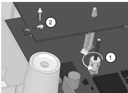
Il n'est pas nécessaire pour le SIMPL'GSM-230 de retirer le circuit d'antenne intégrée.
