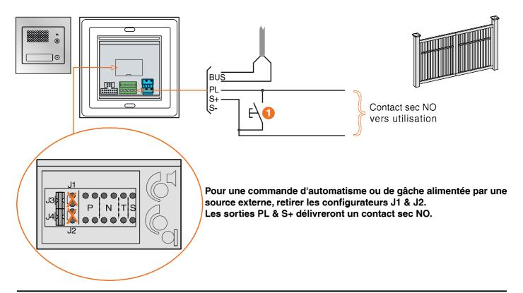
Câblage avec relais de découplage pour commande de ventouse ou gâche électrique à forte consommation.
