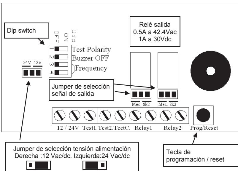
**ATENCIÓN:** Si la alimentación de TCO7RX es realizada con corriente alterna (Vac), la alimentación debe ser obtenida por medio de un transformador de aislamiento (de seguridad, tensiones SELV) que tenga una potencia limitada o al menos una protección contra el cortocircuito
