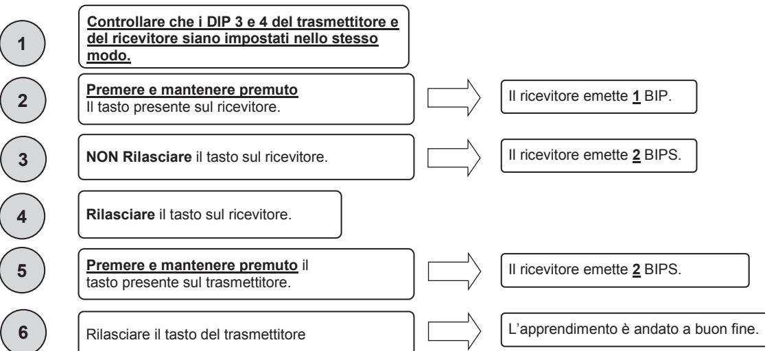
N.B.: Nel caso in cui siano invece riprodotti 4 BIP da parte del ricevitore, significa che è stato raggiunto il numero massimo di trasmittitori per il canale selezionato e non possono essere memorizzati nuovi dispositivi sul medesimo relé.
