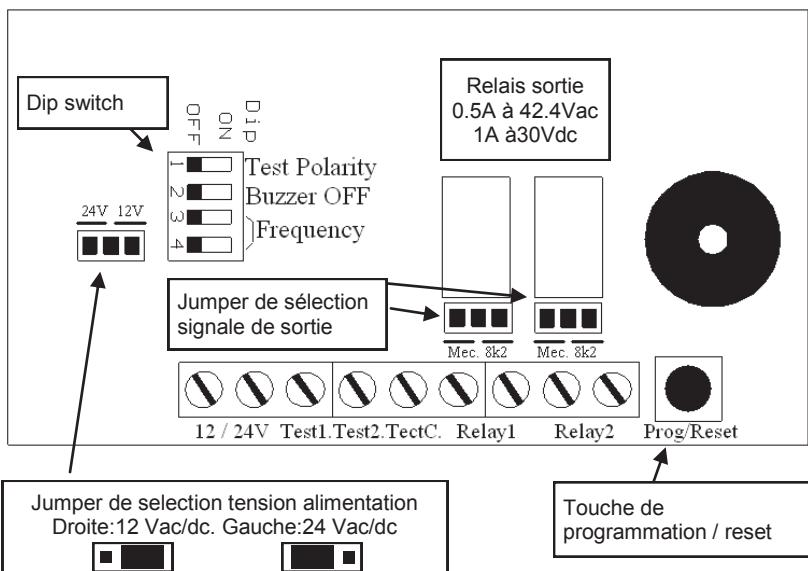
**ATTENTION:** Si l'alimentation du TCO7RX est effectuée en tension alternative (Vac), l'alimentation doit être obtenue à travers un transformateur d'isolement (de sécurité, tension SELV) qui a une puissance limitée ou au moins une protection contre les courts circuits.
