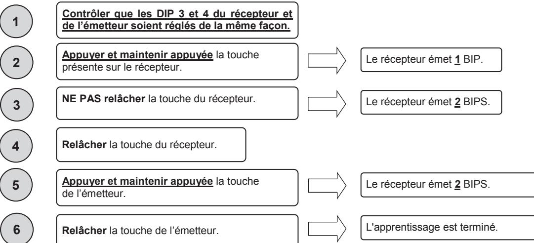
N.B: Dans le cas où 4 BIPS se produisent, cela signifie que le nombre maximum de dispositifs a été atteint pour le canal sélectionné et un nouveau dispositif ne peut pas être mémorisé sur le relais sélectionné.
