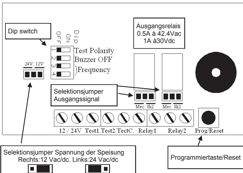
**ACHTUNG:** Falls die Empfangseinheit mit einer Speisung mit Wechselstrom (Vac) erfolgt, muss die Speisung durch einen Isolierungstransformator (Sicherheit, Spannungen SELV) erfolgen, welcher eine begrenzte Kraft oder mindestens eine Sicherung gegen Kurzschluss hat.
