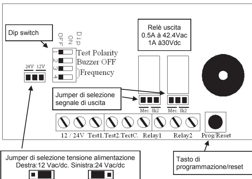
**ATTENZIONE:** Se l'alimentazione del TCO7RX viene effettuata in corrente alternata (Vac), l'alimentazione deve essere ottenuta attraverso un trasformatore d'isolamento (di sicurezza, tensioni SELV) che abbia una potenza limitata o almeno una protezione contro il corto circuito.
